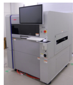
光学外観検査装置
