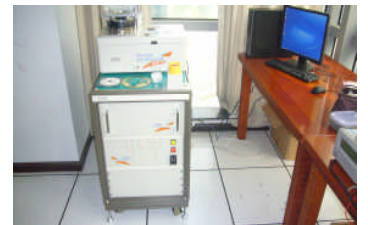
設置した静電破壊自動測定器 HED-S5000R
